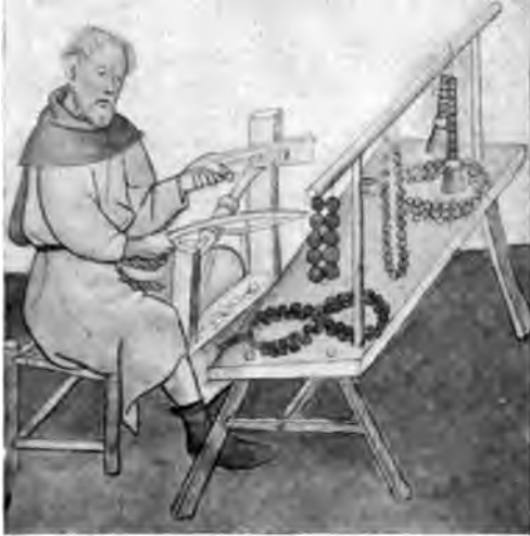
Abb. 77. Fiedelbohrer zum Ausschneiden von Rosenkranzperlen, um 1390.
