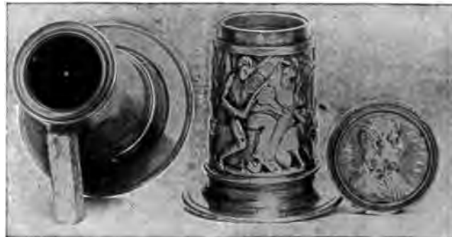
Abb. 498. Nadelniveau, um 1560. Links das umgelegte Instrument. In der Mitte das aufstehende Instrument. Rechts der Deckel desselben. Mathematisch-physikalischer Salon Dresden.
