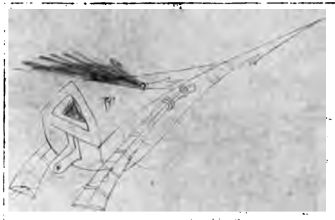
Abb. 756. Automobilier Torpedo, durch Ra- keten vorwärts getrieben, 1420.
