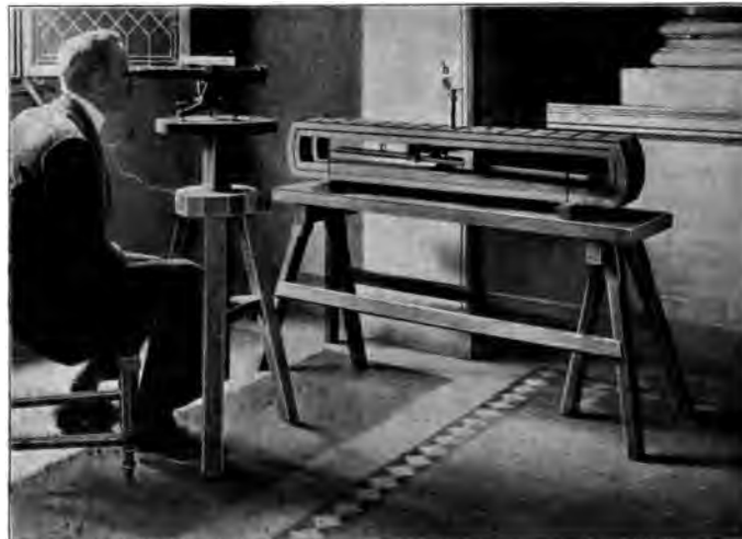
Abb. 748. Telegraph von Gauss und Weber (Empfänger, dessen Bewegungen durch das Fernrohr beobachtet werden). Postmuseum Berlin.
