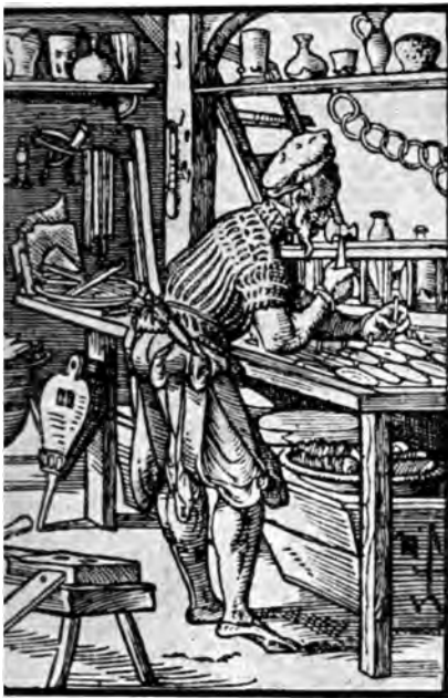
6. Glaserwerkstätte um 1568, nach dem chnitt von Jost Amman. Links vorn ein erk für Fensterblei, dahinter ein Löt- it LötKolben, andere LötKolben an der Wand hängend.
