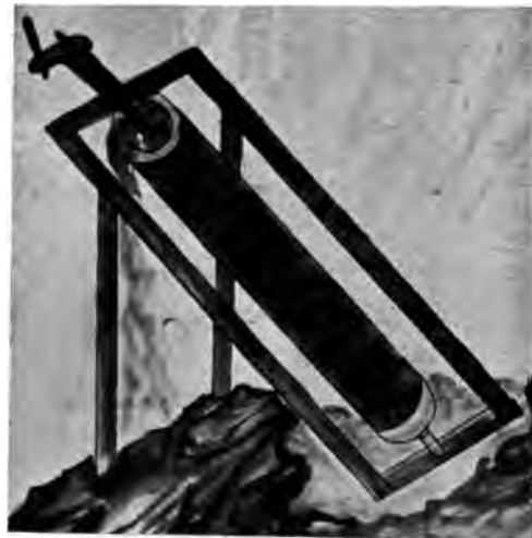
Abb. 545. Schraubepumpe nach Kyeser, 1405.
