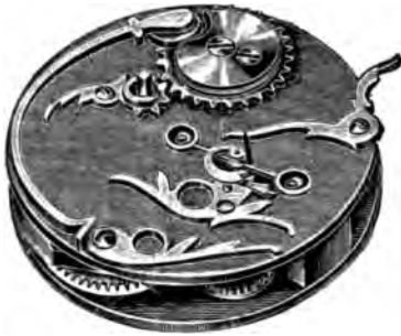
Abb. 773. Das eiserne Werk zu der in Abb. 772 dargestellten Taschenuhr.
