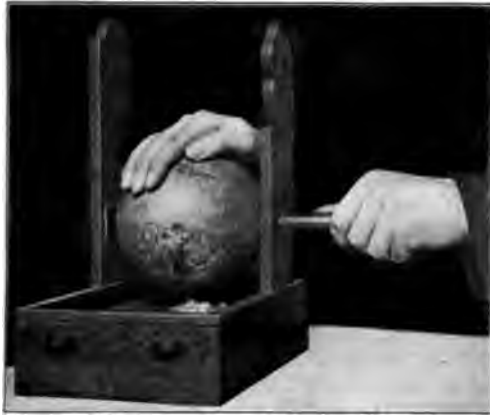
Abb. 169. Elektriermaschine von Guericke. Nachbildung im Postmuseum zu Berlin.
