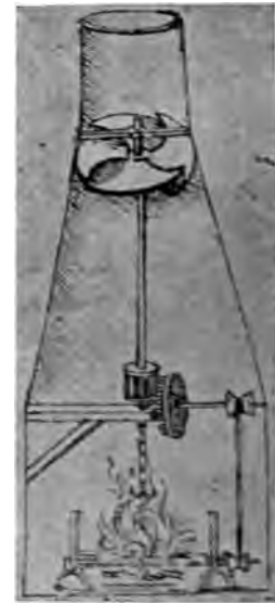
Abb. 98. „Rauchhanel“, Bratenwender mit Warmluftturbine nach Leonardo, um 1500.
