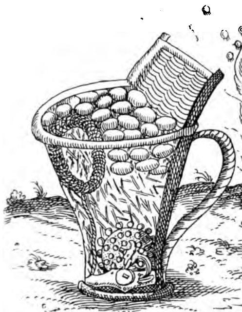
Abb. 360. Höllenmaschine. Unten ein Steinschloß, das durch Zug an dem oben sichtbaren Kranz ausgelöst wird, 1620.
