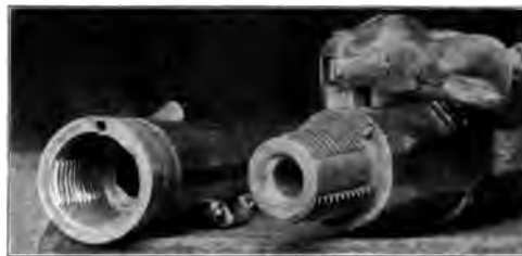
Abb. 286. Hinterladegewehr von Gull, 1658. Rechts der Kolbenteil mit dem Schloß, links der Lauf.
