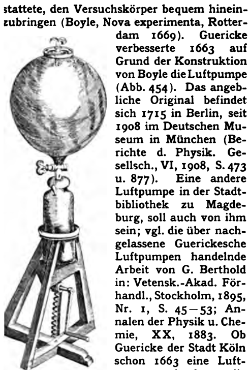
Abb. 453. Luftpumpe von Boyle, Nova experimenta, 1669.
