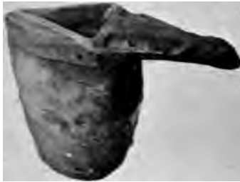
Abb. 636. Schmelztiegel mit scharfkantigem Ausguß und Griff, aus dem späten Mittelalter; nach M. Rosenberg, Gesch. d. Goldschmiedekunst auf technischer Grundlage , Frankf. 1910.
