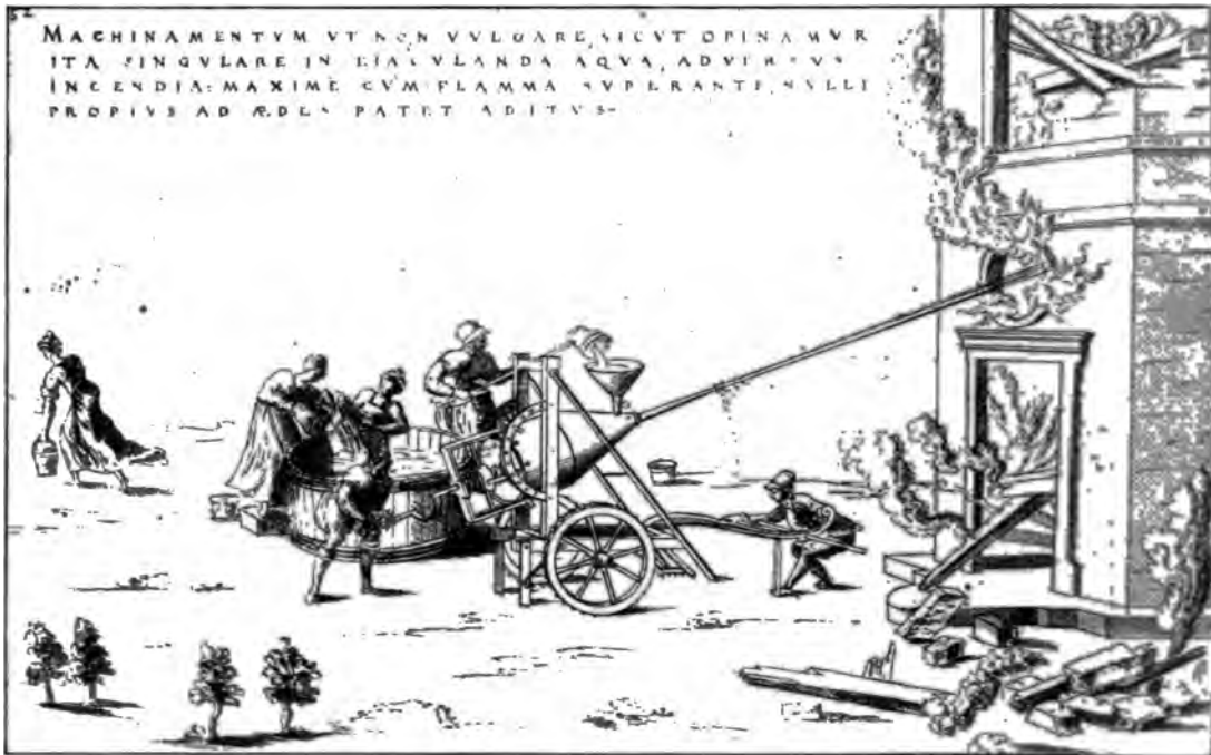
Abb. 206. Feuerspritze auf Wagen, nach Besson, Théâtre des Instruments, Lyon 1578.
