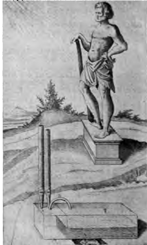
Abb. 698. Sonnenkraftmaschine, die beim Auf- und Untergang der Sonne Luft in die Pfeifen drückt. Im Vordergrund Schnitt durch die Maschine, die im Sockel der Figur versteckt ist.
