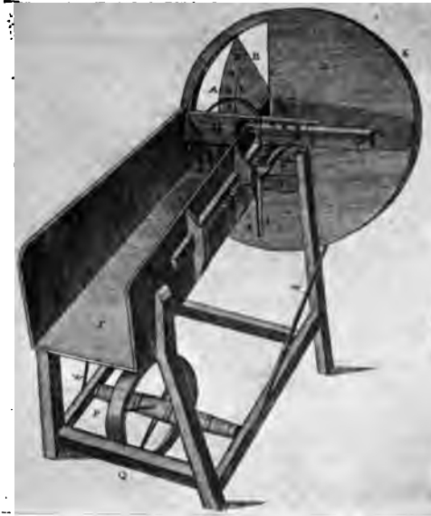
Abb. 329. Englische Häcksellade mit rotierendem Messer, um 1768.
