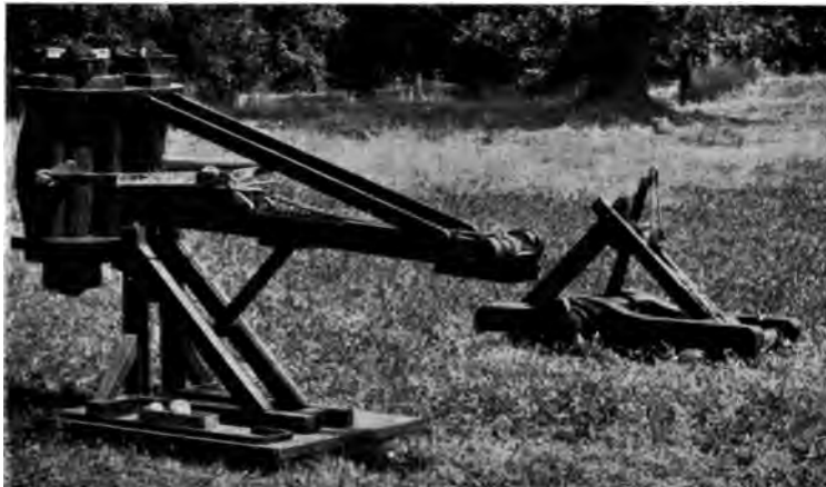
Abb. 249. Steilbahngeschütz (Palintonon) um 330 v. Chr., links, und Steinschleuder (Onager) um 375 n. Chr., rechts; beide Geschütze auf der Saalburg rekonstruiert; beide Geschütze für Kugeln.
