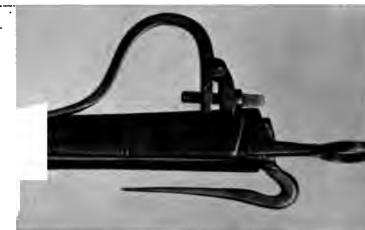
Abb. 299. Die sogenannte Mönchsbüchse in der Gewehrgalerie zu Dresden mit Steinzündung.
