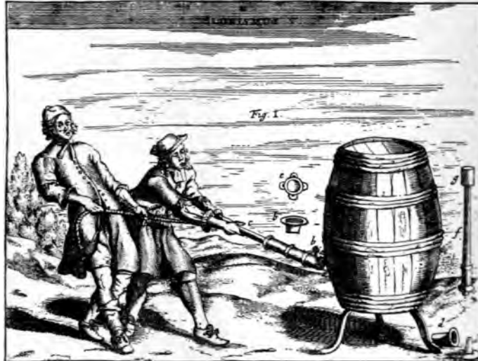
Abb. 451. Guericke's Versuch mit der Luftpumpe, die aus einer Feuerspritze besteht. Nach Guericke, Experimenta nova, 1672.
