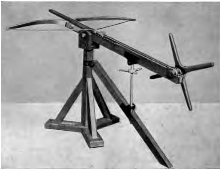
Abb. 247. Pfeilgeschütz mit elastischen Bogenarmen, nach Angabe von Hermann Wesch rekonstruiert, auf der Saalburg. Man beachte die elastischen Bogenarme im Gegensatz zu den unelastischen Armen der folgenden Abbildungen. Die Schraube für die Höhenrichtung wurde versuchsweise hinzugefügt, entspricht aber nicht der Römerzeit.
