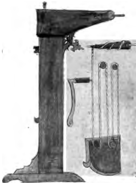
Abb. 21. Armbrustwinde mit konischer Seiltrommel, nach Kyeser, 1405.
