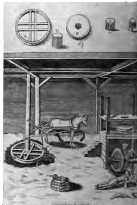
Abb. 321. Göpel zum Antrieb einer Mühle und einer Schleiferei. Unterirdische Achse. Nach Zonca, 1607. Vgl. die Göpelanlage von Zonca beim Stichwort: Schiffszug.
