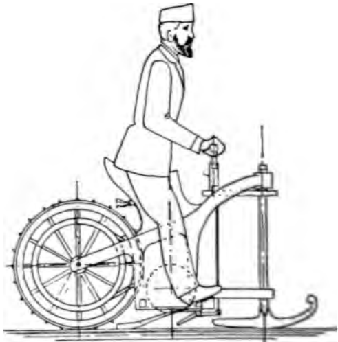
Abb. 629. Der erste Kraftschlitten, nach der Patentschrift von Daimler, 1885.
