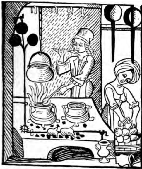
Abb. 100. Bratenwender mit Schwungkugeln, 1507.
