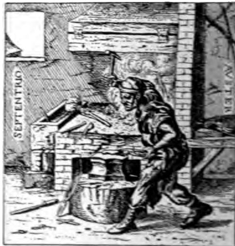
Abb. 638. Magnetisieren durch Schlagen, nach W. Gilbert, De magnete , 1600.
