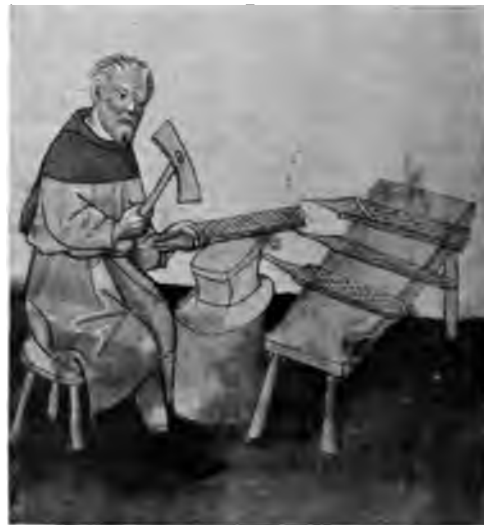
Abb. 196. Feilhauer, Nürnberg 1417; er haut zwei sich kreuzende Hiebreihen.
