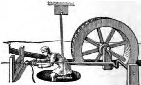
Abb. 142. Mechanisches Drahtziehen, nach Biringucci 1540 (eine Vereinigung der Schaukel [Abb. 137] mit dem Wasserrad).
