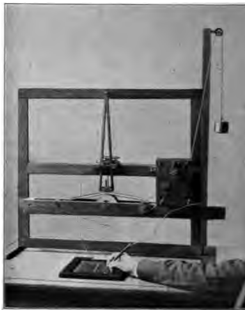
Abb. 749. Telegraph von Morse. Unten der Geber, dahinter der Empfänger.
