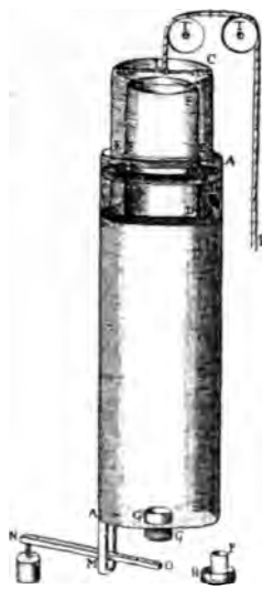
Abb. 240. Schießpulvermaschine von Papin, nach Acta Eruditorum 1688. Das Schießpulver wird in P eingefüllt und durch eine Lunte abgebrannt. Die Explosion wirft den Kolben B in die Höhe. Außenluft drückt den Kolben zur Arbeitsleistung hinunter, nachdem die Gase durch ein im Kolben sitzendes Ventil entwichen sind.
