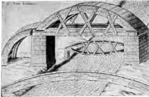
Abb. 114. Holzbrücken nach Veranzio, um 1595. Im Vordergrund ein verzahnter Träger, der aus kurzen Stücken zusammengesetzt ist. In der Mitte eine Hängewerkbrücke auf Steinpfeilern. Im Hintergrund eine Brücke mit nach oben und unten hin gewölbtem Träger.
