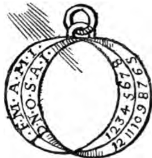
Abb. 771. Tragbare Sonnenuhr nach Harsdörffer, Delic. mathem., Nürnberg 1651, S. 341.
