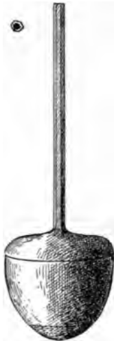
Abb. 350. Stechheber, römisch. z. B. zu Alatri (Merckel, S. 561), zu Lyon (ebenda, S. 562). — Kyeser zeichnet und beschreibt 1405 (Bl. 59 v) den gebogenen Heber, um ein Faß zu entleeren. Auf Bl. 61 v zeichnet er einen Heber (Abb. 351), der über einen Berg führt:
